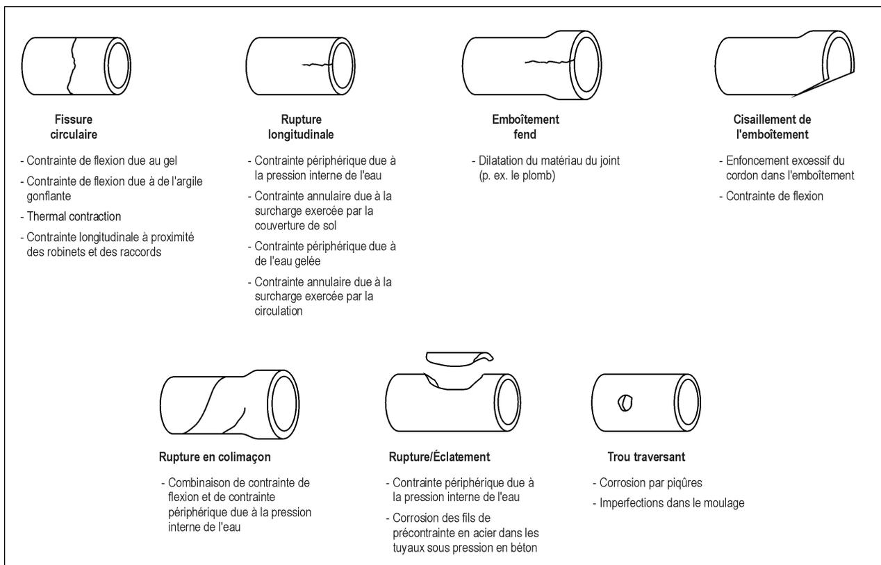
**Figure 2-1 : Modes de défaillance des conduites de distribution**
